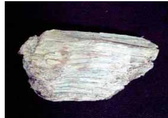
Amiante blanc (Chrysotile)
