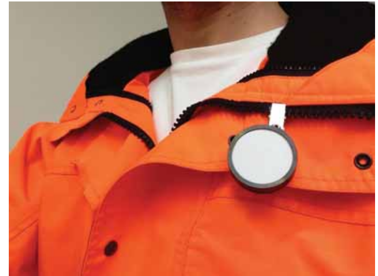
Badge diffusif / (tamis moléculaire carboné) pour le prélèvement passif des COV (TOXpro 2012)
